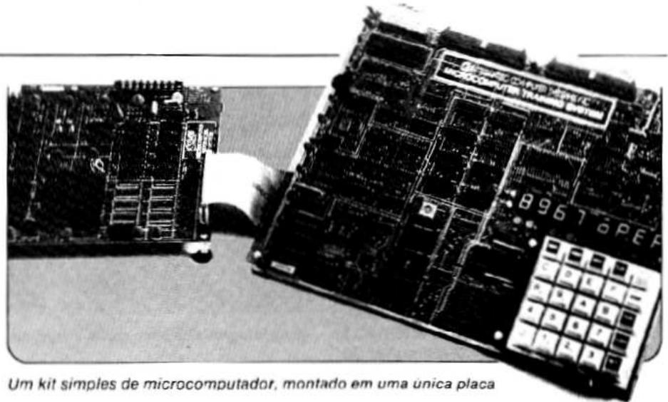
Um kit simples de microcomputador, montado em uma única placa
